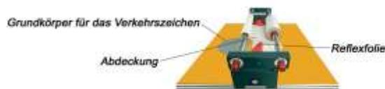
Wenn 2 Folienstücke nebeneinander verklebt werden sollen (Spleißen), dürfen diese nicht überlappen. Abhängig vom Format, sollte der Abstand etwa 1 mm betragen. Bitte achten Sie darauf, dass die rechte Seite der Folienbahn immer an eine linke Seite verklebt wird, so dass eine einheitliche Ausrichtung der Honigwabenstruktur der Folien gewährleistet ist (siehe unten).
